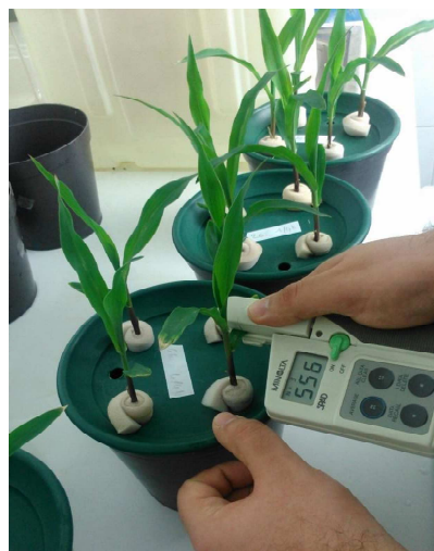
5. kép A relatív klorofill tartalom (SPAD érték) mérése fiatal kukorica növények idősebb levelén (Saját fotó, 2017)
