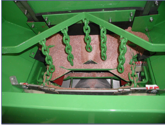
11. ábra. A fenéklemez háromszög alakú kivágása és a műtrágyaoszlató láncok
