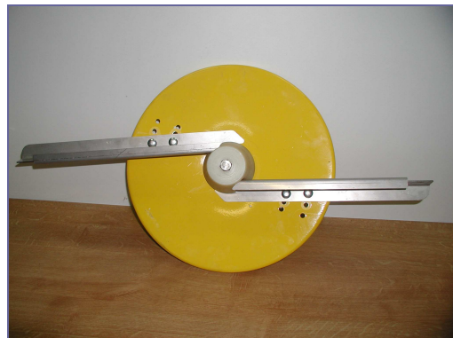
18. ábra. Lapátszög állítási lehetőségek a röpitőtárcsán
