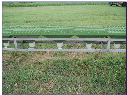
22. ábra. A rácsokkal ellátott mérőtálcák, az alattuk elhelyezett mérődobozokkal
