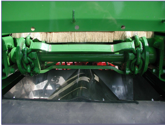
15. ábra. A műtrágyaelosztó szerkezet
