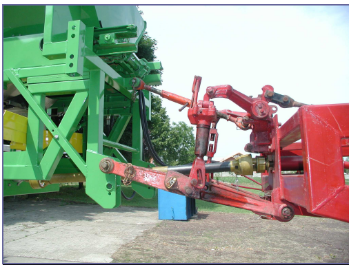
21. ábra. A műtrágyaszóró gép rögzítése és hajtása
