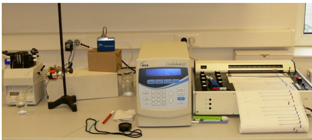
7. ábra: Az első készülék összeállítás (balról: perisztaltikus pumpa, manuális injektor, enzimmegőrző (injektor mögött), amperometriás cella, amperometriás detektor, regiszter)
