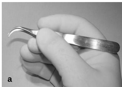
21. ábra. A hajlított csipesz helyes tartása a: lefele tekintő, b: felfele tekintő pozícióban
