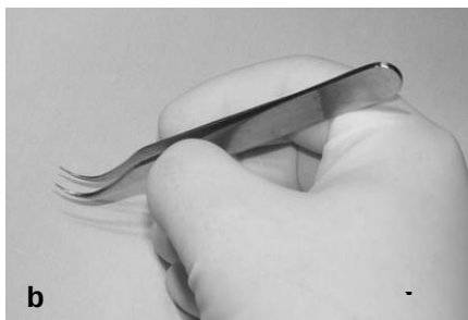
21. ábra. A hajlított csipesz helyes tartása a: lefele tekintő, b: felfele tekintő pozícióban
