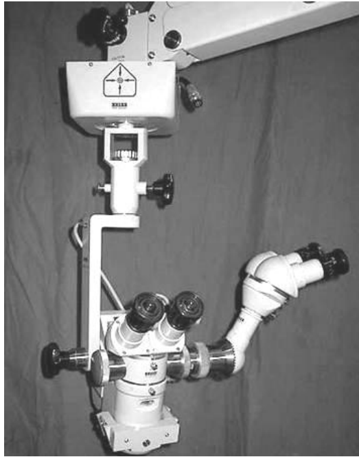
14. ábra. Operáló mikroszkóp állványzattal, szatellit okulárral
