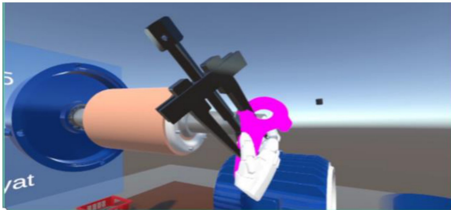
52. ábra. Az elhasználódott csapágy levétele VR környezetben (Saját készítésű ábra)
