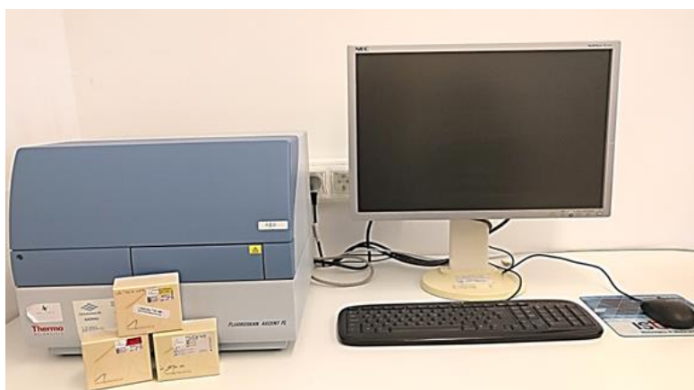
5. ábra. Fluoroskan Ascent FL fluoriméter és a CAT assay
