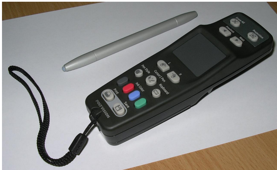
5. ábra Az interaktív tábla távirányítója és a speciális toll
