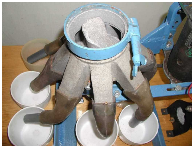
18. ábra. A rotációs szétosztó felépítése
