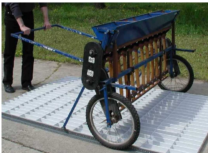
15. ábra. Szórás egyenlőtlenségi mérések az átalakított Fiona/1.5 parcella-műtrágyaszóró géppel
