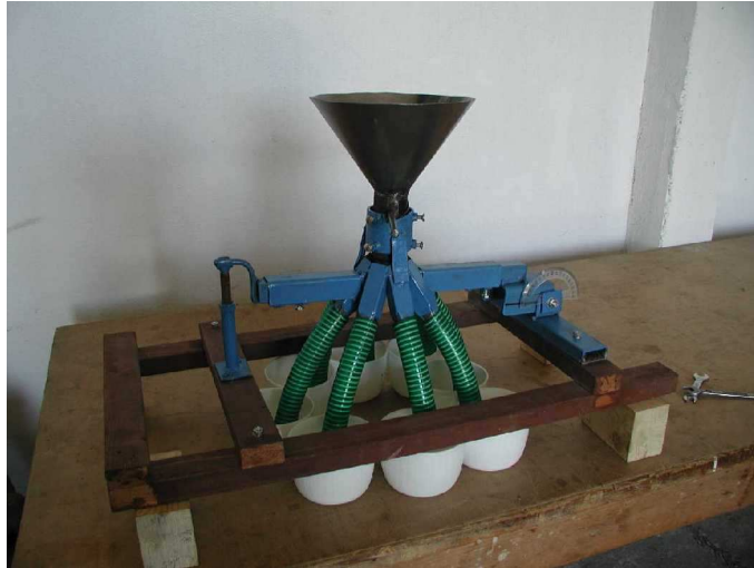
17. ábra. Vizsgálópad a gravitációs osztókúp ellenőrzéséhez
