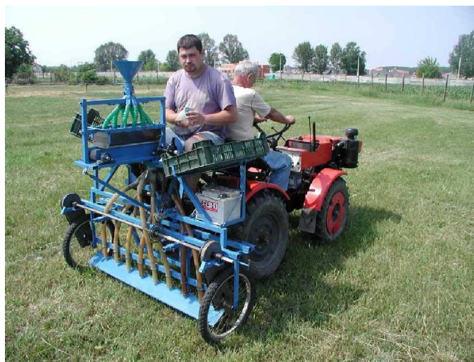
53. ábra. A kísérleti parcella-műtrágyaszóró gép
