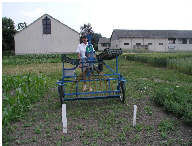
51. ábra. A kísérleti parcella-műtrágyaszóró gép kézzel tölt változata
