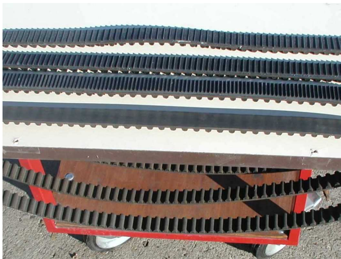
22. ábra. Különböző fogosztású fogazott lapos szíjak a kísérleti modellhez
