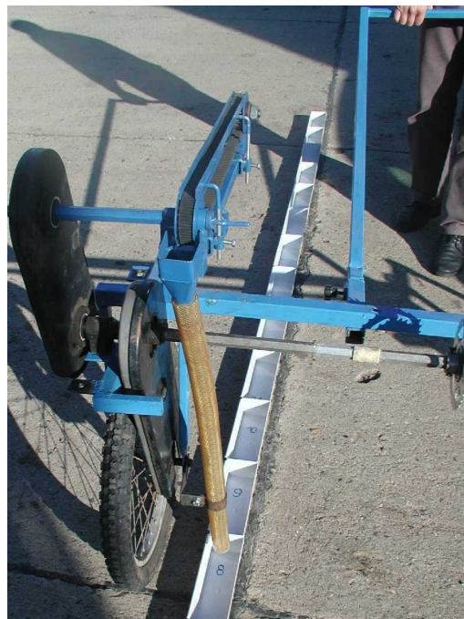
21. ábra. A hevederes modell kialakítása és hosszirányú szórás egyenlőtlenségének vizsgálata
