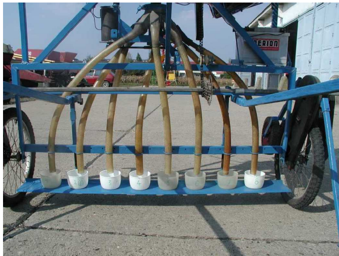
23. ábra. Adagolás egyenlőtlenség vizsgálata
