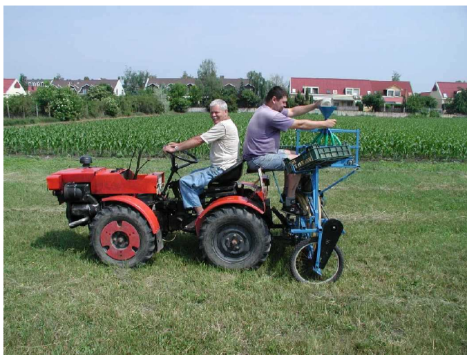
50. ábra. A kísérleti parcella-műtrágyaszóró gép traktorral vontatott változata
