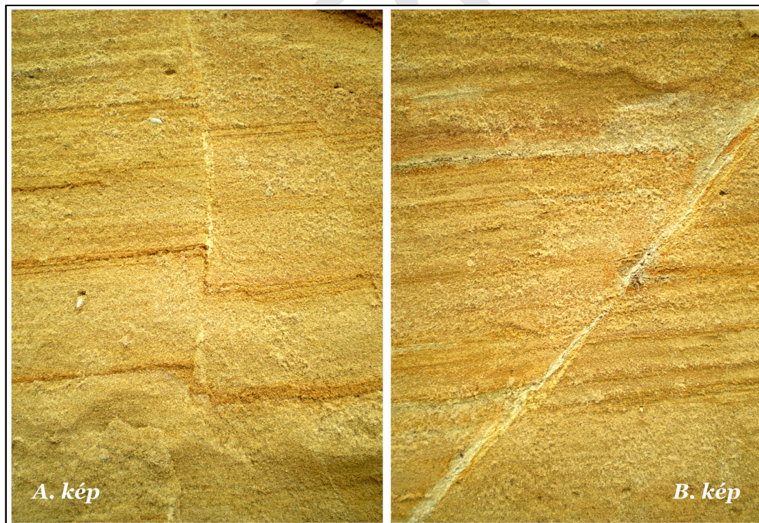
9. színes tábla: Mésszel kitöltött vetősíkok egy rétegzett kavicsos homokban mélyített munkagödör oldalfalán. A kép: függőleges vetősík. B kép: ferde vetősík.
