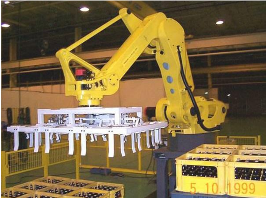
1. ábra: Anyagmozgató robot (forrás:[4.]).
