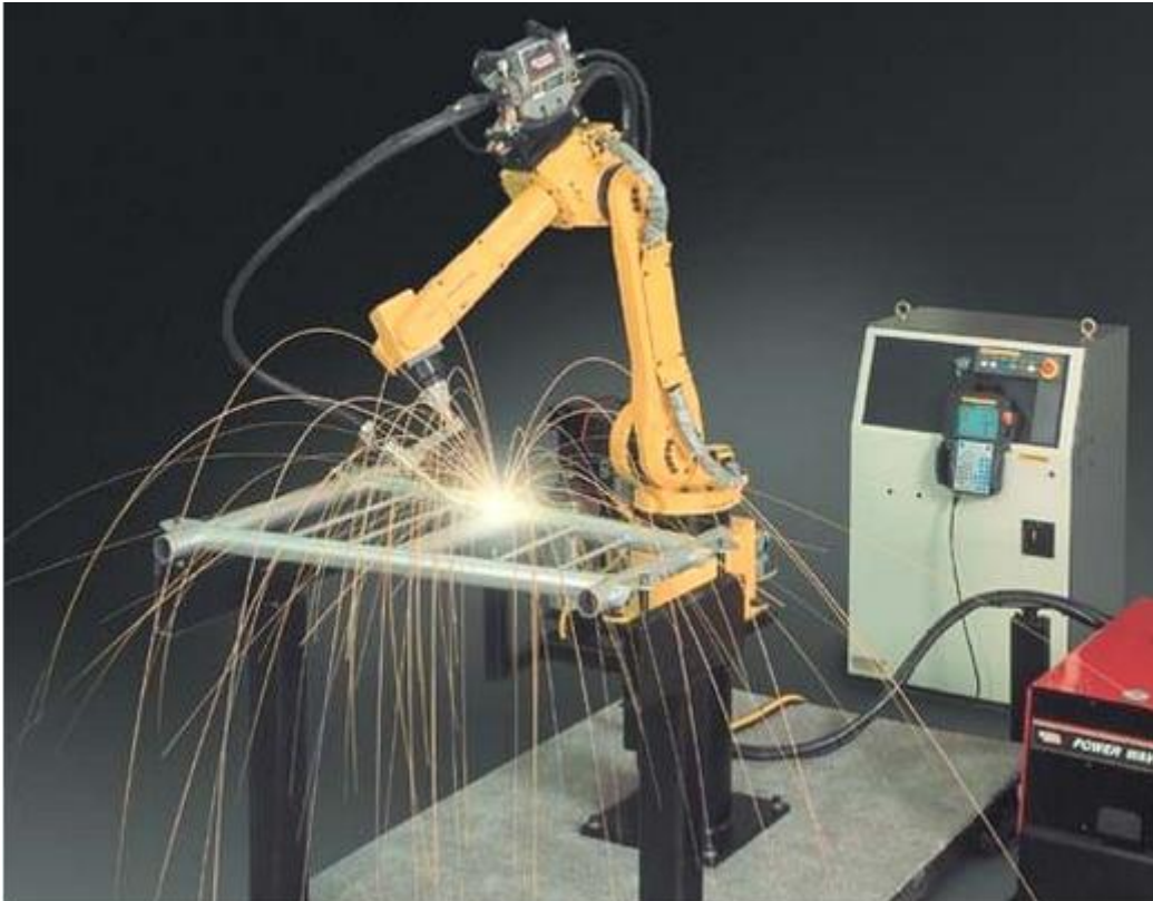
2. ábra: Hegesztő robot (forrás:[4.]).
