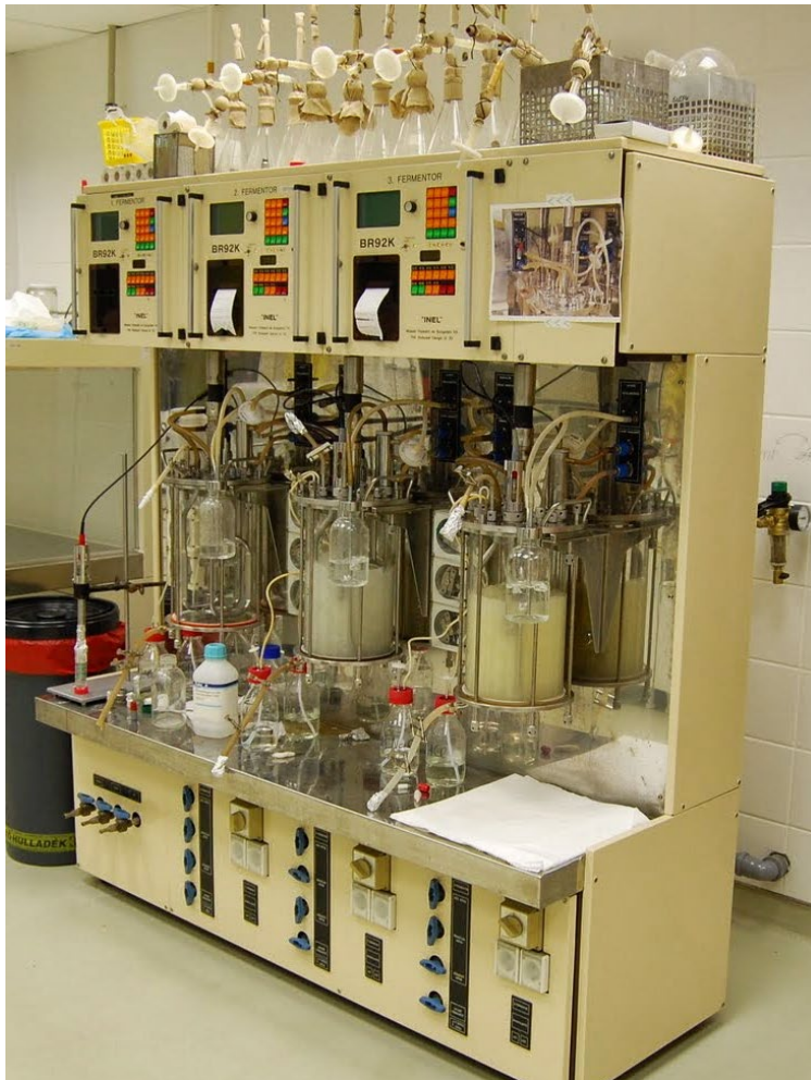
21. ábra: Zentai 12 l-es laboratóriumi fermentor (bioreaktor B)
