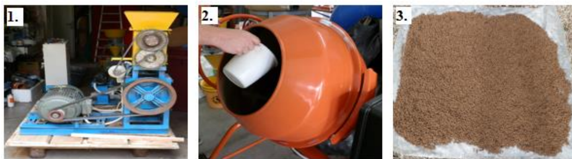
4. kép: A kísérleti tápok elkészítése: (1.) Pelletáló berendezés, (2.) Homogenizálás, (3.) Az elkészült takarmány szárítása
