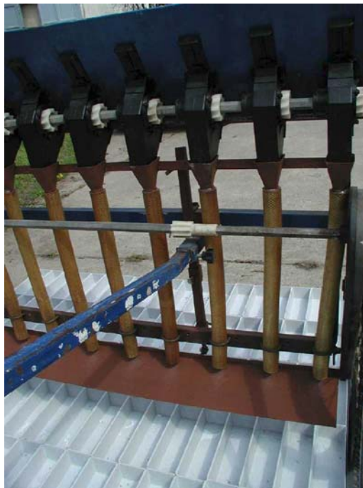
1. ábra. Az átalakított FIONA/1.5 parcella-műtrágyaszóró gépen a műtrágya talajfelszínre juttatása
