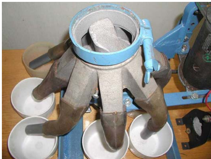
3. ábra. A rotációs szétosztó vizsgálata.
