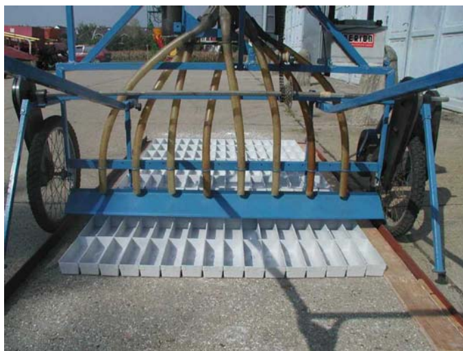
4. ábra. Szórás egyenlőtlenesség vizsgálat teljes felületen elhelyezett mérő tálcákkal
