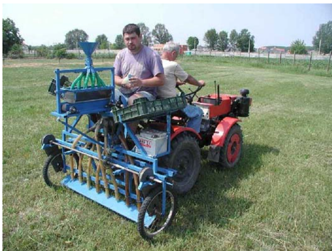
9. ábra. A tervezett és fejlesztett kísérleti parcella-műtrágyaszóró gép
