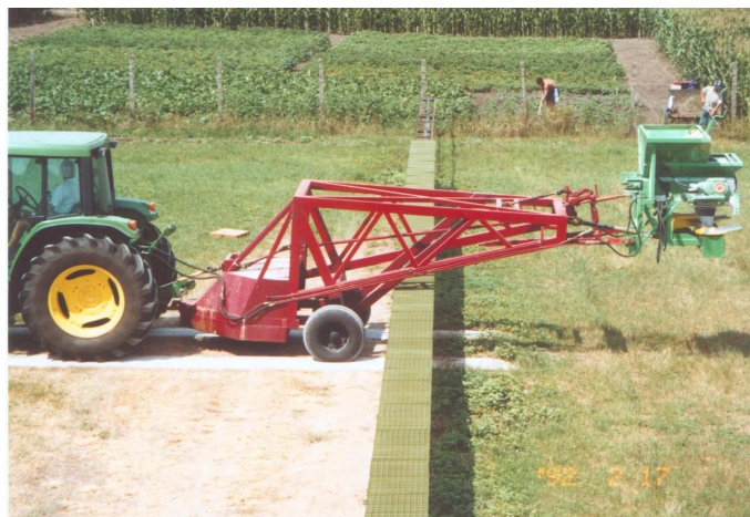
15. ábra. 50 m széles mérőpálya függesztett gépek vizsgálatához
