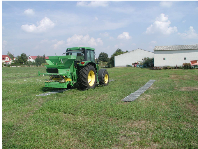
19. ábra. Hosszirányú szórás egyenlőtlenség mérés
