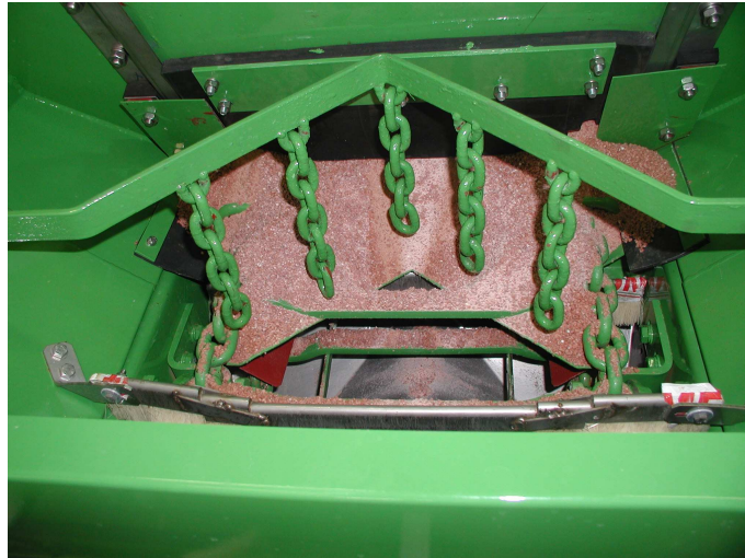
7. ábra. A fenéklemez kivágása az osztató láncokkal
