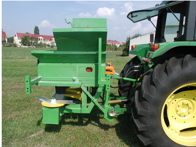
4. ábra. Függesztett, röpítőtárcsás kísérleti műtrágyaszóró gép
