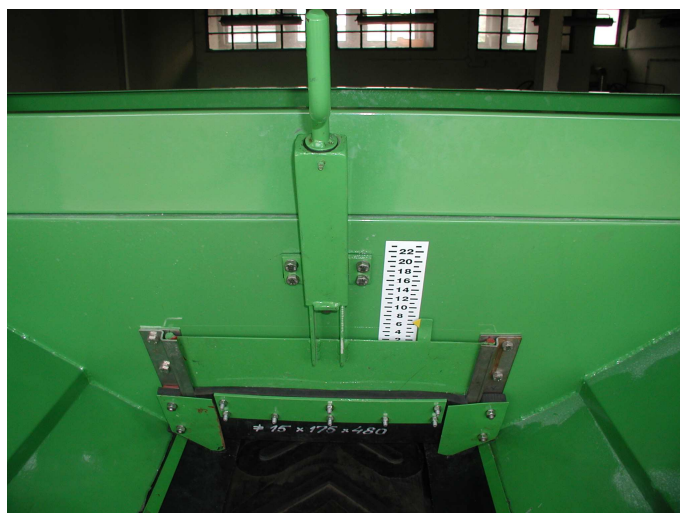
8. ábra. Résállító szerkezet a beállító skálával
