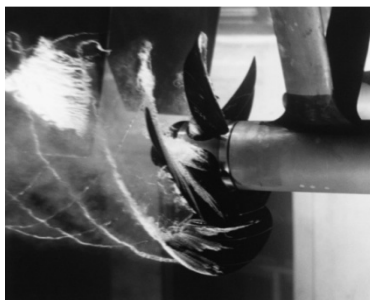
48. ábra. Kavitaló hajócsavar
