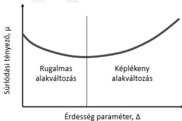
11. ábra. A súrlódási tényező és érdességi paraméter kapcsolata
