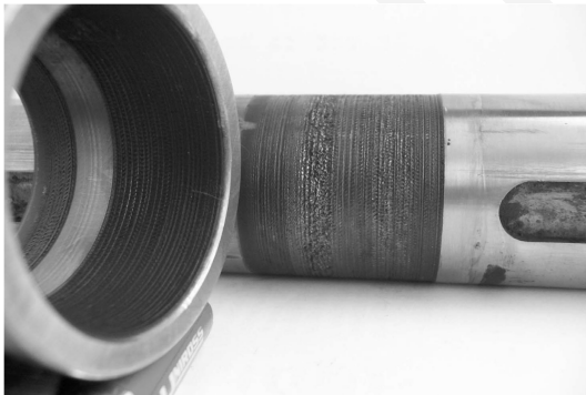
56. ábra: Az oxidációs kopás (fretting) folyamata (súrlódási folyamatot erős oxidáció kíséri)
