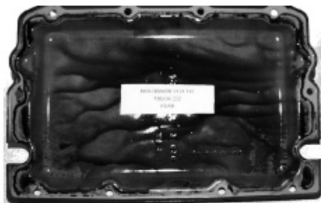
32. ábra. Erősen lerakódott felület, rossz DD (detergens-diszpergens) hatású olaj
