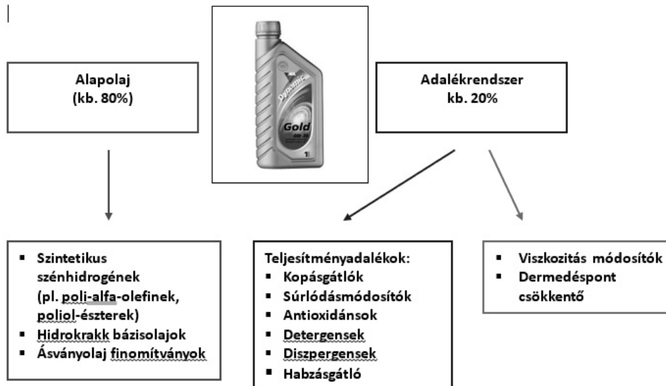
68. ábra. Motorolaj általános felépítése
