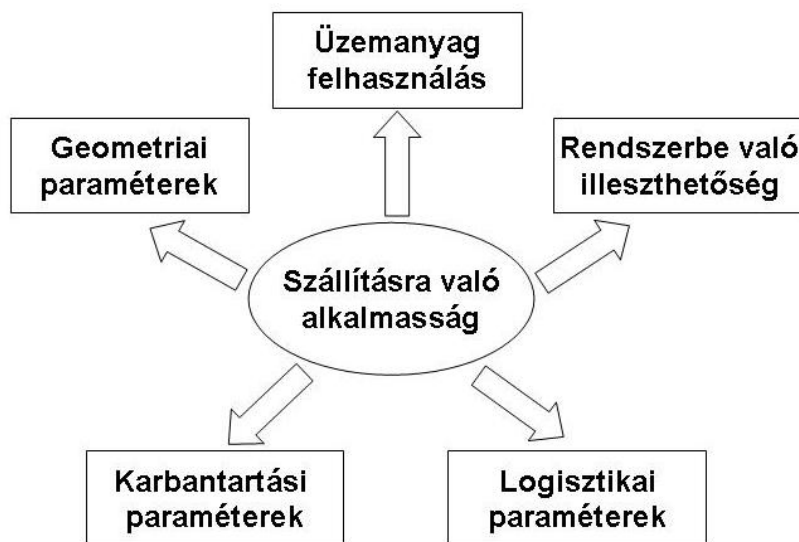
22. ábra: A targoncák szállításra való alkalmasságát befolyásoló alapvető tényezők. (forrás [19.] átdolgozott ábra).
