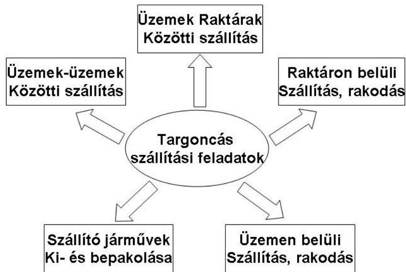
21. ábra: A targoncás feladatok funkciók szerinti csoportosítása (forrás: [19.] átdolgozott ábra).
