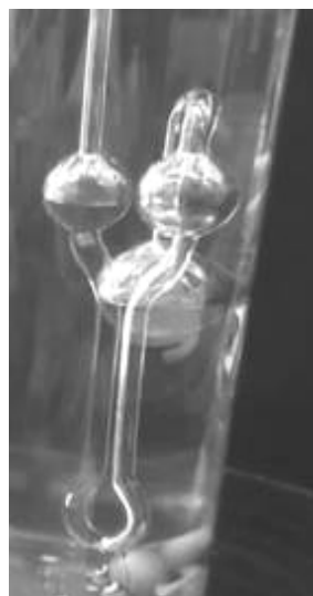
204-1. ábra: Izoteniszkóp segédmanométerrel
