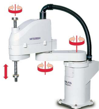
Az RH-SDH robot mozgástengelyei
