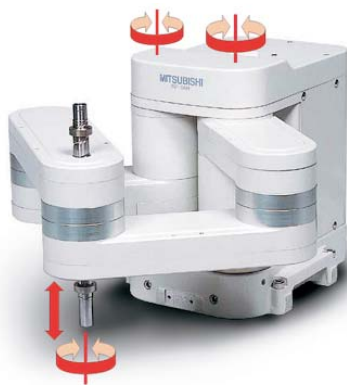
Az RP-AH robotok mozgástengelyei
