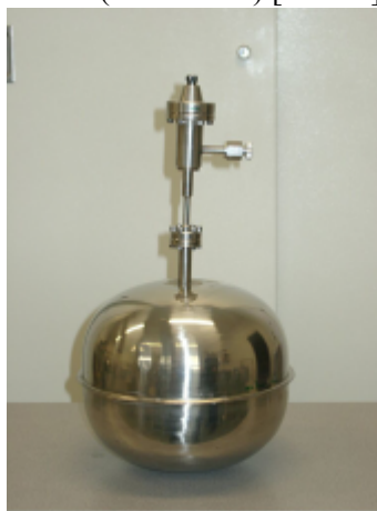
4.1.1. ábra: A tríciummérésekhez használt fémlombik, rajta fémszelep
