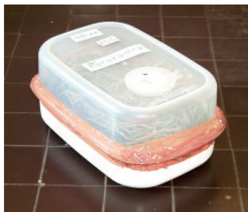
1. fénykép. Fuminta a lezárt pára kamrában
