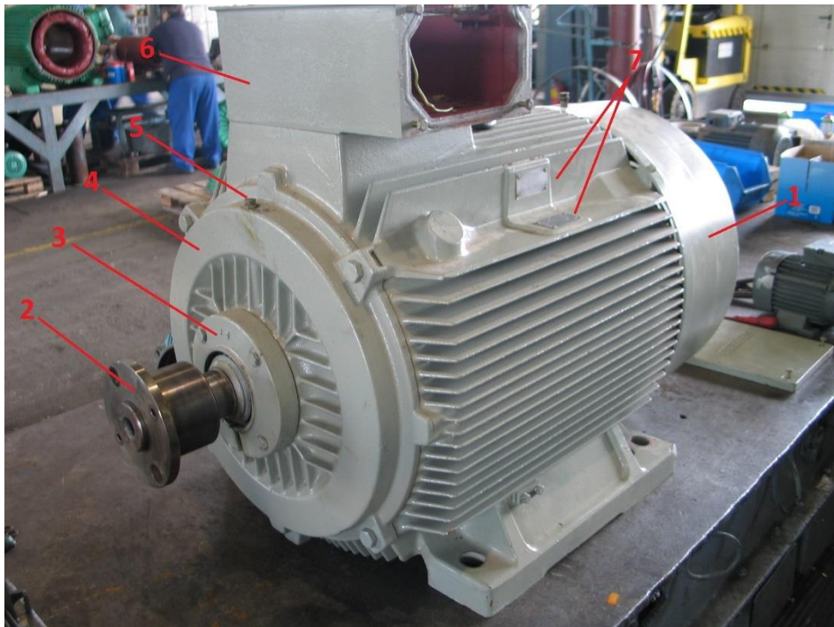
41. ábra: 75 kW-os felújított villamos motor (saját)
