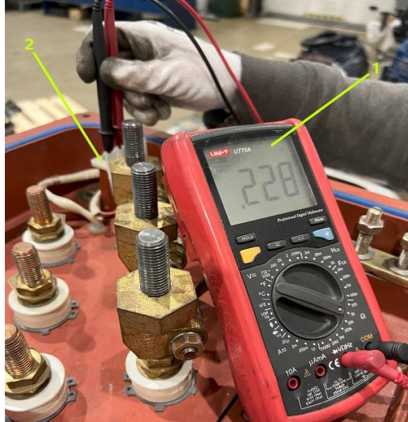
74. ábra: Javítás utáni hőelem mérés (saját) 1 Digitális multiméter; 2 Hőelemek
