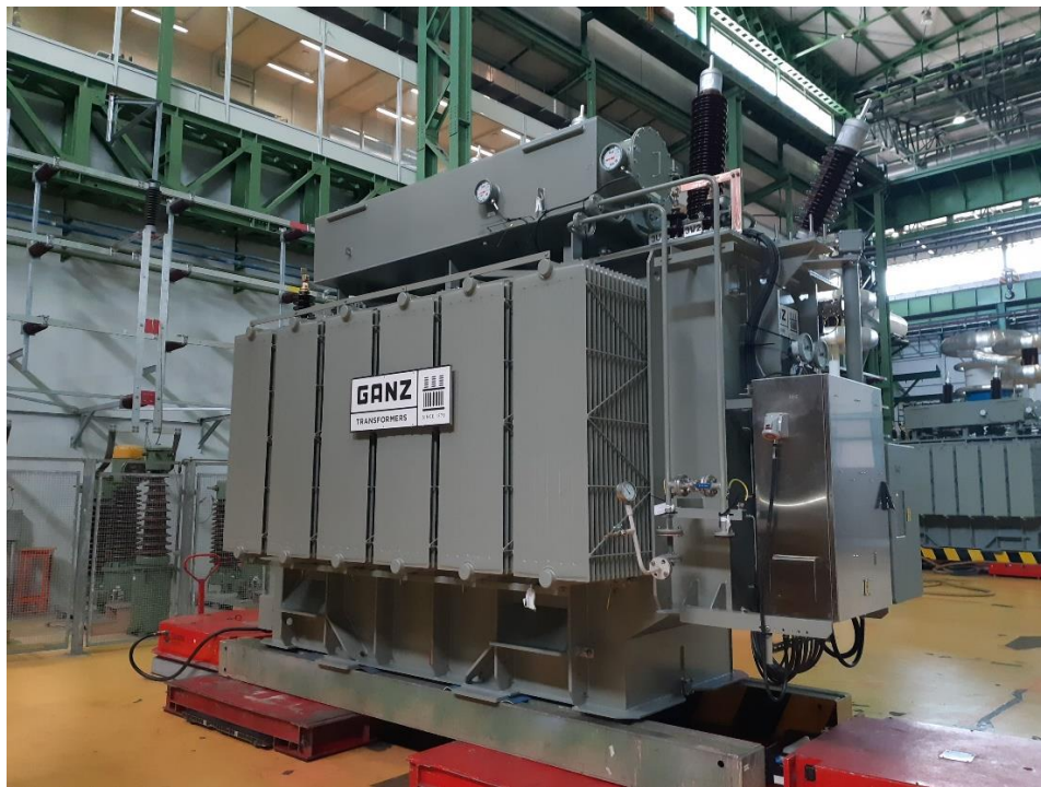
4. ábra: Magyar gyártmányú intelligens transzformátor [6]
