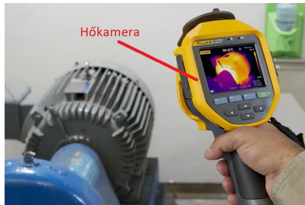
20. ábra: Villamos motor hőkamerás vizsgálata Fluke Infrared kamerával [22]
