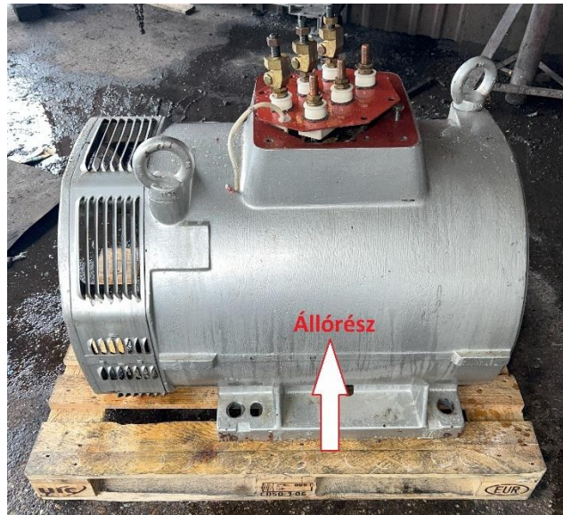
52. ábra: Az állórész tisztítása (saját)
