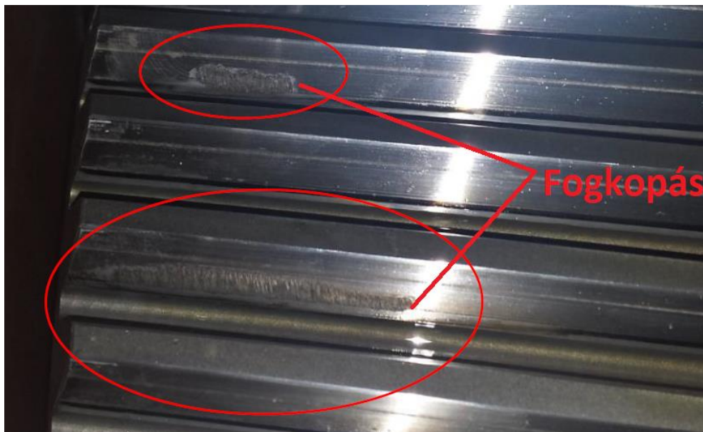
30. ábra: SPM HD Envelope módszerrel kimutatott fogaskerék fogkopás (saját)
