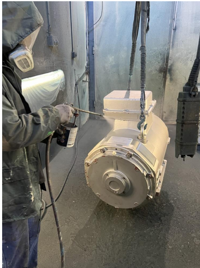
40. ábra: Villamos motor felújító festése (saját)
