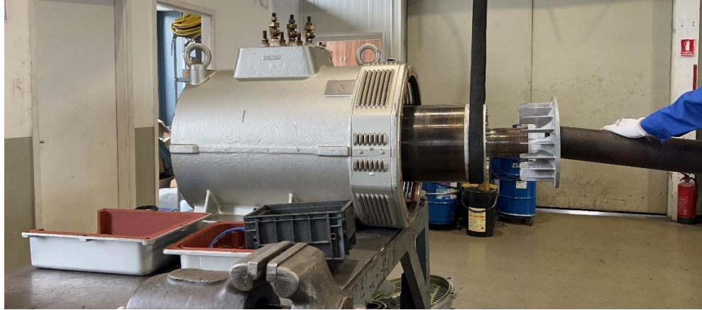
66. ábra: Forgórész befűzése az állórészbe (saját)
