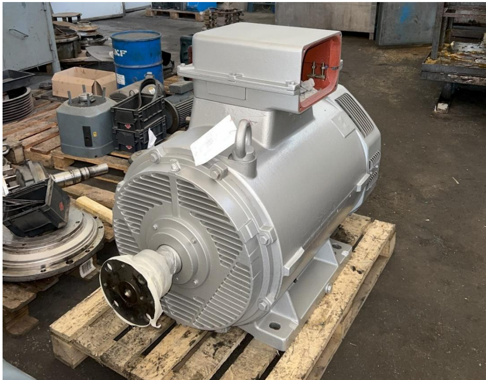
76. ábra: Teljesen felújított villamos motor (saját)
