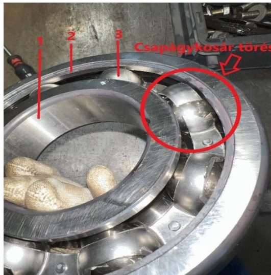
50. ábra: 6316/C3 csapágykosár törés (saját)
