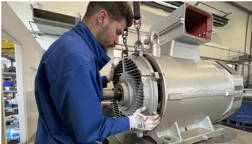
69. ábra: Hajtás oldali pajzs felhelyezése (saját)
