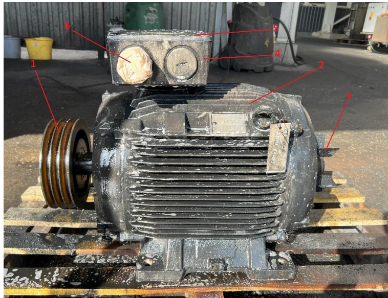
36. ábra: Koromgyári motor oldószeres tisztítása (saját) 1 Ékszíjtárcsa; 2 Állórész; 3 Ventilátor lapát; 4 Kapocsház; 5 Kapocsfedél; 6 Tömbszelenc
