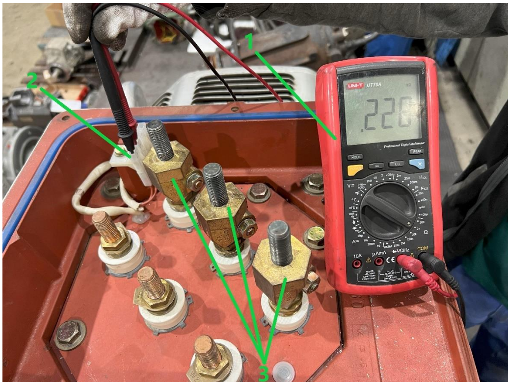
43. ábra: Hőelem vizsgálata (saját)
