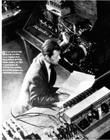
15. ábra: Az EDVAC, a Moore School-ban tervezett második, de már tárolt programú, soros működésű elektronikus, elektroncsöves számítógép. (1945)
