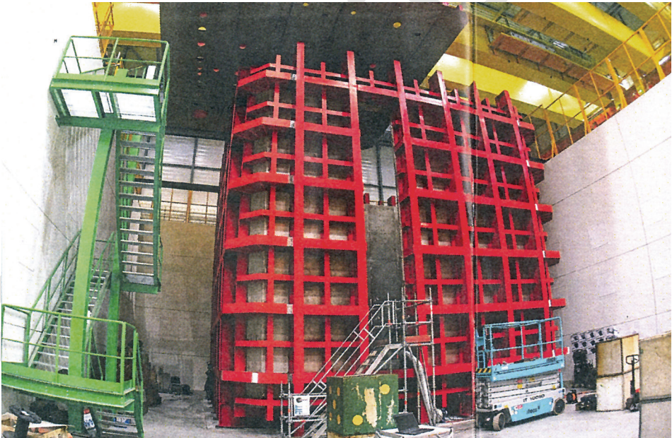
Felül: A Fermi-laboratórium központi épülete Chicago mellett Alul: A Fermi-laboratórium DUNE-programjához készülő berendezés prototípusa. Ez kriosztátot, detektort és kb. 800 tonna folyékony argont tartalmaz. L. részletesebben a IV. 1. alfejezetben
