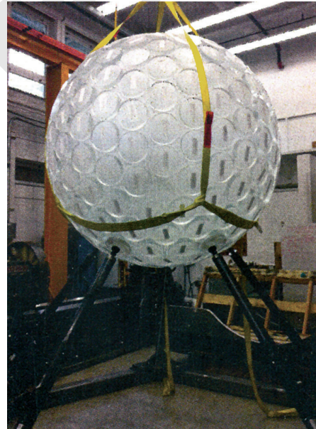
Felül: A SNOLAB (Kanada) föld alatti laboratóriumának felületi épülete Alul balra: A SNOLAB „COUP” 4 kg-os sötétanyag-kutatásra használt kvarc buborékkamra detektora. A buborékkamrát kívülről sztereokamerákkal figyelik Alul jobbra: A SNOLAB „DEAP-360” sötétanyag-detektora szerelés közben. A 3600 kg-os folyékony argon detektort 266 fotoelektron-sokszorozó figyel. L. részletesebben a VI. 4. alfejezetben
