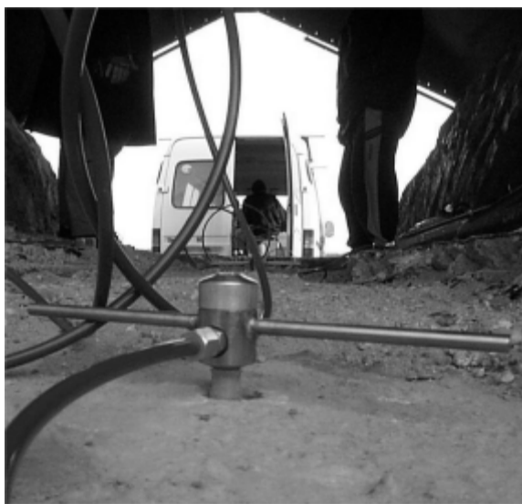
4.1.2.2 ábra: A cella betonfödémjébe juttatott mintavevő szeg
