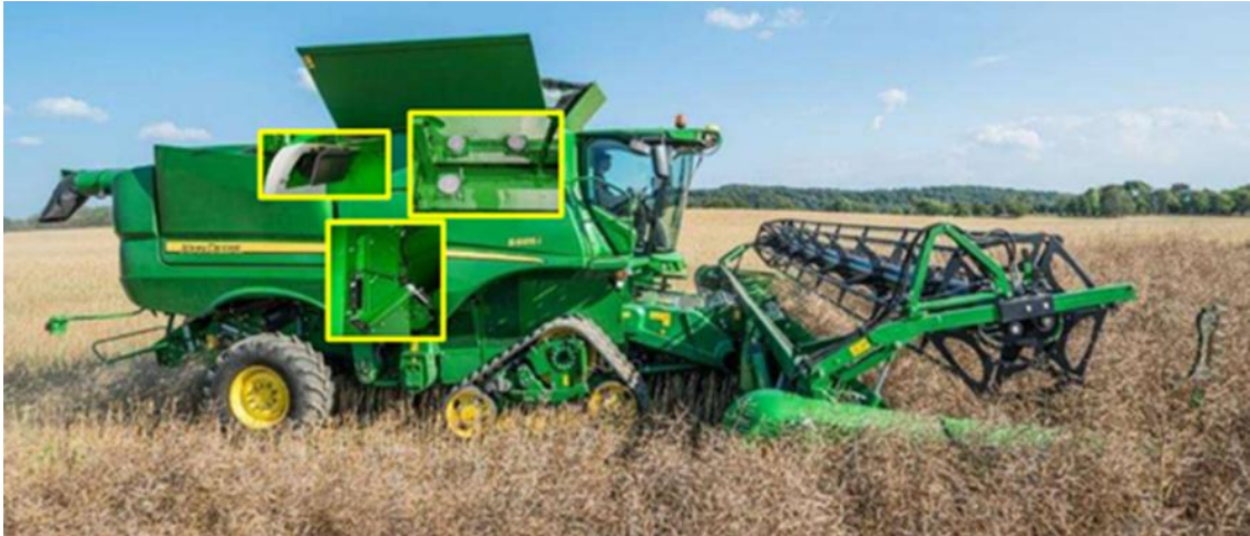
5.kép. A Harvest Monitor hozamtérképező rendszer mérőegységei. Forrás: Hajmásy, 2019.
