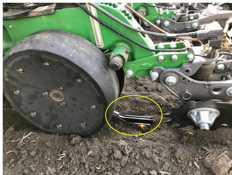
17. kép. A SmartFirmer™ magmegfogó pálca. (saját felvétel)
