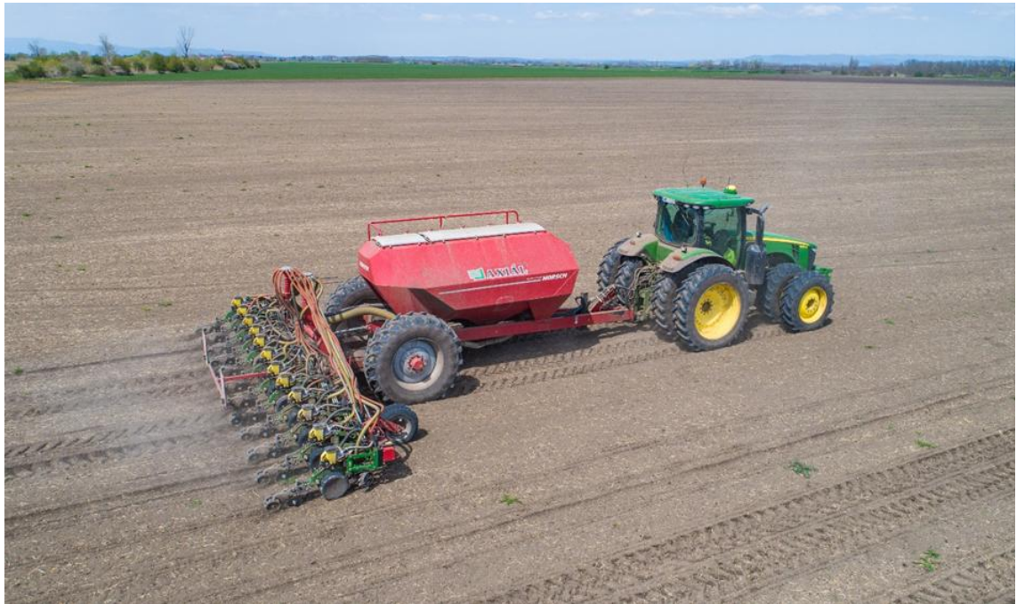
10. kép. A kísérleti vetéshez használt egyedileg szerelt precíziós szemenkénti vetőgép és traktor. Fotó: Demeter Péter (Petya AgroTV)
