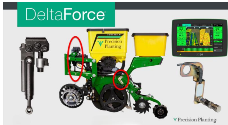
12. kép. A DeltaForce™ talajnyomástartó rendszer. Forrás: Precision Planting weboldal
