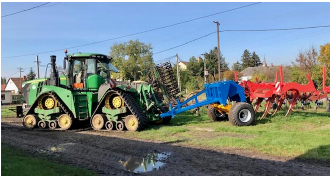
3. kép. Gumihevederes járószerkezetű erőgép és vontatott eszközhordozóra szerelt középmélylazító (saját felvétel)
