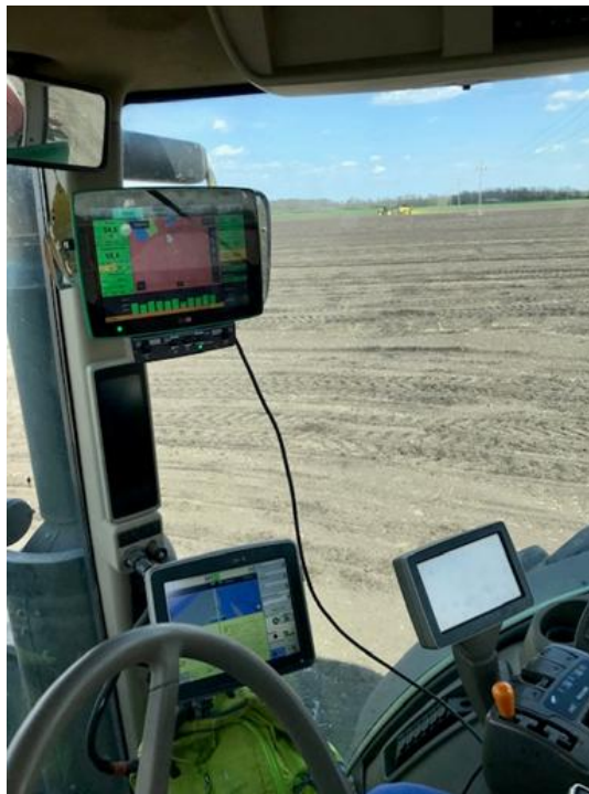
11. kép. A traktor fülkében használt Precision Planting 20|20™ monitor (fent), a traktor saját John Deere GreenStar™ (GS3) 2630 monitorja (balra lent), valamint CommandCenter™ monitor (jobbra lent). A kép háttérében a preemergens gyomirtási művelet zajlik. (saját felvétel)
