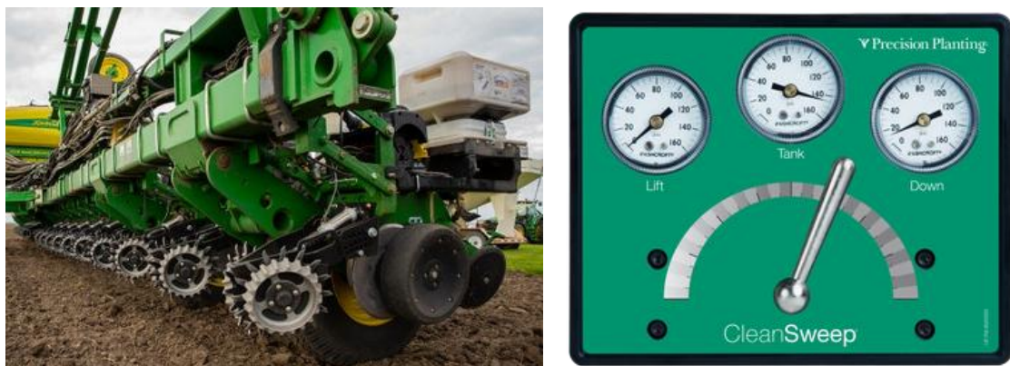
13. kép. A CleanSweep™ sávtisztító rendszer. Forrás: Precision Planting weboldal
