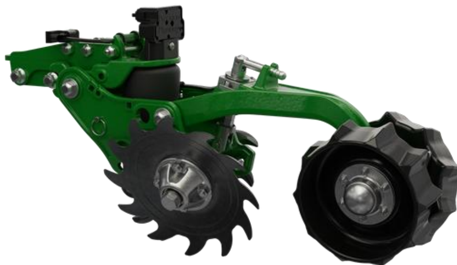
15. kép. Kétlépcsős lezáróegység. Forrás: Precision Planting weboldal.
