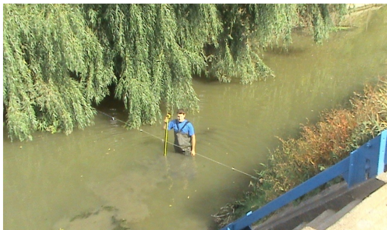
11. kép: A Berettyó meder keresztmetszvény felvétele közben
