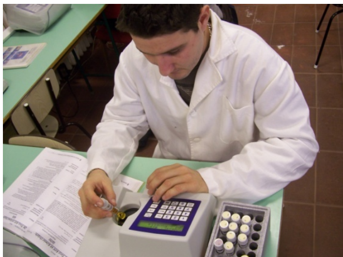
8. kép: Az ammóniumion mennyiségének meghatározása fotométerrel
