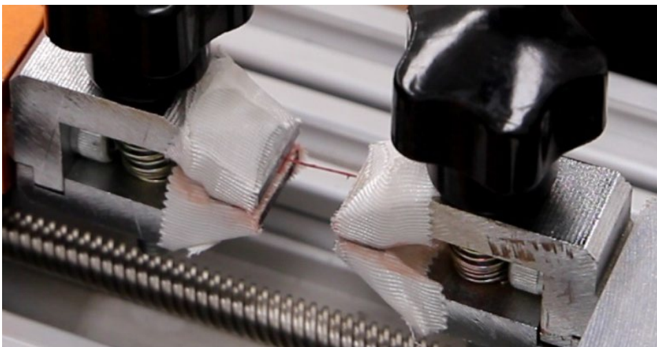
16. ábra Szakítószilárdság mérés
