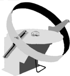
3.7. ábra Diffúz sugárzásmérést végző Kipp & Zonen piranométer
