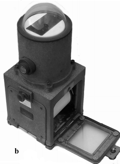
3.6. ábra (a) A Robitzsch-féle sugárzásíró régebbi és (b) újabb modellje
