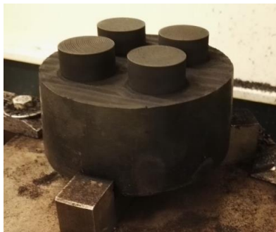
2.4. ábra. A mintavételezett próbatetek és elhelyezkedésük a gumiterméken belül
