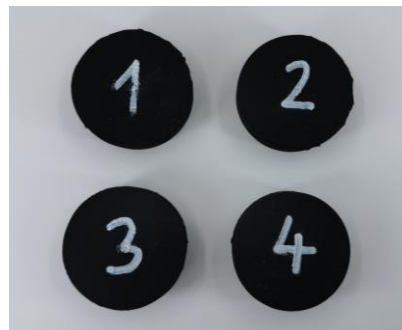
2.4. ábra. A mintavételezett próbatetek és elhelyezkedésük a gumiterméken belül
