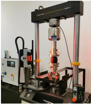
2.3. ábra. A gumitermék nyomóvizsgálata alatti mérési felépítés és a működési karakterisztika
