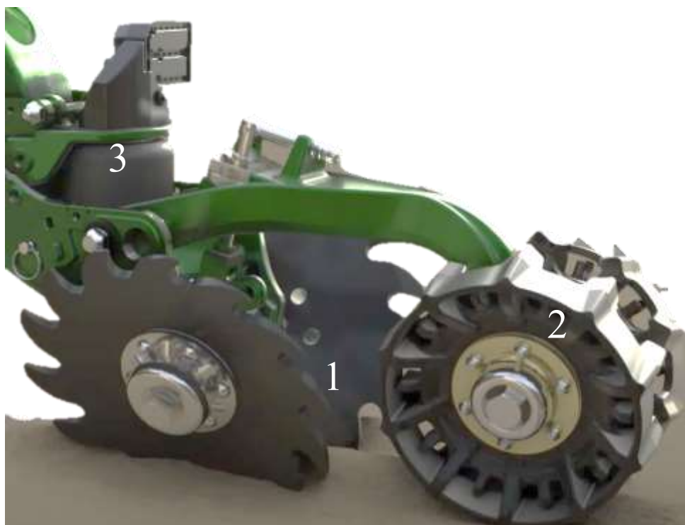
13. ábra Mechanikus magárok lezáró rendszer és működése, forrás: saját szerkesztés, 1- szögben álló tárcsapár, 2- lezáró kerek, 3- pneumatikus munkahenger
