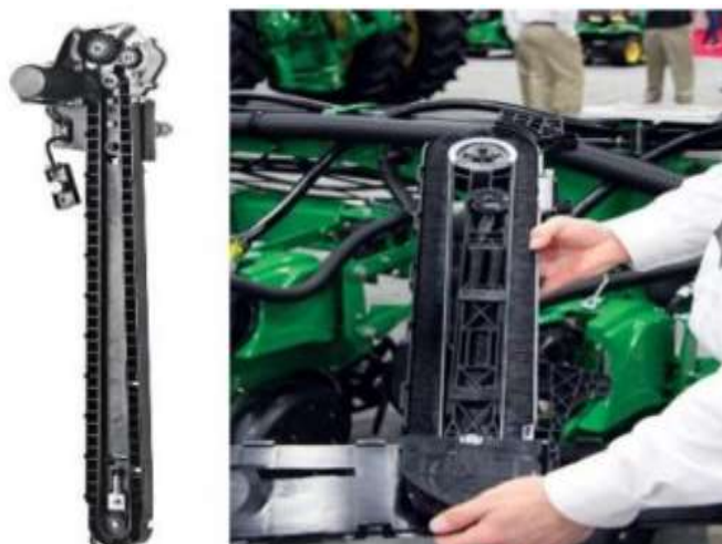
6. ábra Szállítószalagos magszállító rendszer, saját szerkesztés
