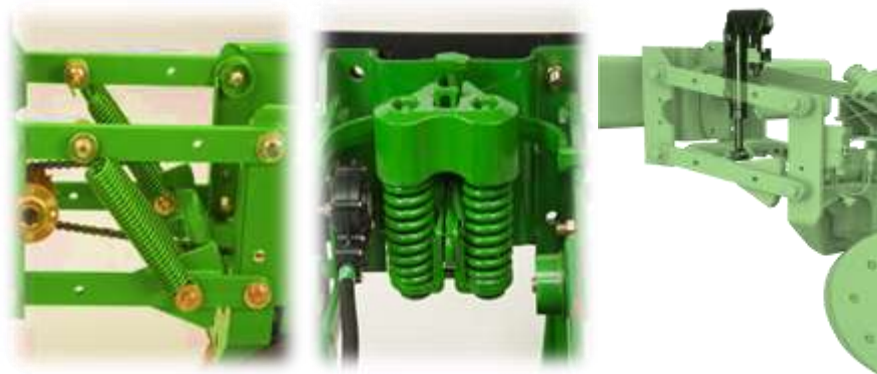
11. ábra A beépített különböző vetőkocsi terhelő rendszerek (mechanikus húzó rugó, mechanikus nyomó rugó, hidraulikus vezérelt). Forrás: saját szerkesztés
