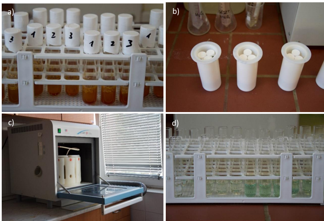
7 ábra: A nyers propoliszok roncsolása: a) a kvarccsövek teflonszalaggal lezárva, b) a lezárt kvarccsövek a teflonedényben, c) a minták a mikrohullámú roncsolóban, d) a minták a roncsolást követően
