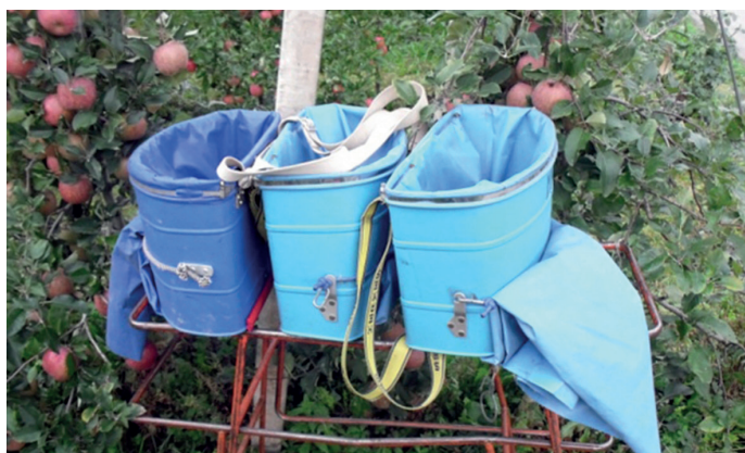
132. kép: Testre függeszthető szedőedények (Forrás: saját felvétel)
