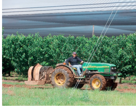
166. kép: Cseresznyeültetvény szárítása eső után repülőgép hajtómű segítségével (Forrás: Gonda István)
