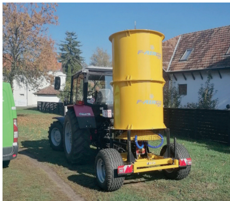
159. kép: F-AirGo fagyvédelmi gép (Forrás: saját felvétel)
