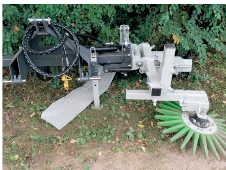
98. kép: Ujjas-tárcsás gyomirtó eszköz ( Forrás: saját felvétel )
