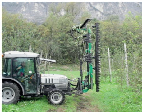
119. kép: Alternálóképes síkfalmetsző (Forrás: saját felvétel)
