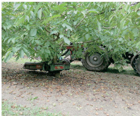
124. kép: Rázógép működés közben diófán (Forrás: saját felvétel)
