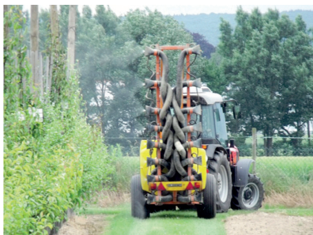
122. kép: Osztott szóró szerkezettel szerelt permetezőgép (Forrás: saját felvétel)
