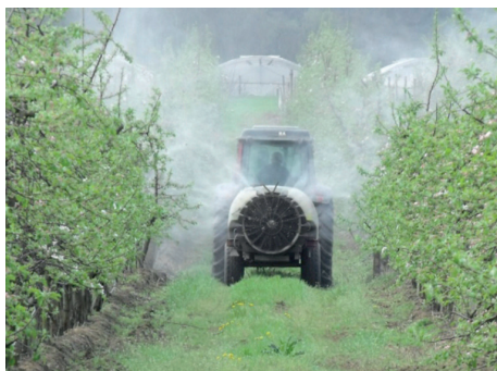
121. kép: Központi szóró szerkezettel szerelt permetezőgép (Forrás: saját felvétel)
