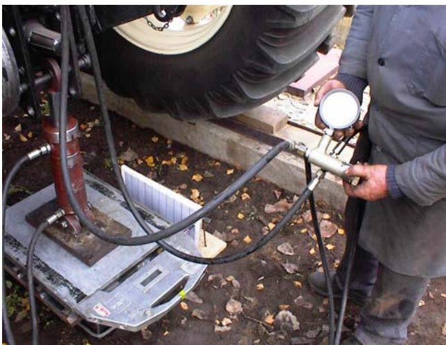
21. ábra A függőleges nyomóerő beállítása a szabályozható hidraulikus munkahenger segítségével
