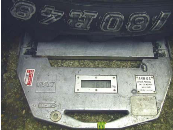
20. ábra A PAT SAW 10 C típusú digitális talpmérleg és műszaki jellemzői
