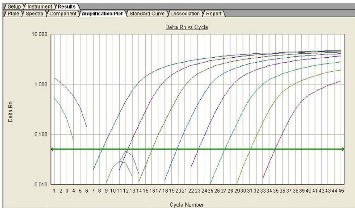
9. ábra. Real-time PCR, a SYBR Green fluoreszcencia detektálása a PCR ciklusszám függvényében. Jelnek a zöld vízszintes vonal feletti fluoreszcencia intenzitást tekintjük.
