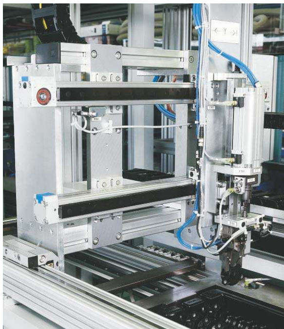
36. ábra. Háromdimenziós portál alkalmazhatósági területe
