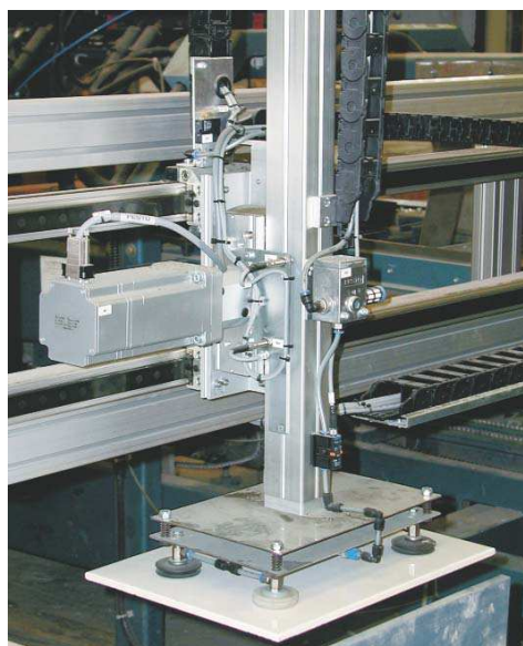
34. ábra. Lineáris portál alkalmazhatósága
