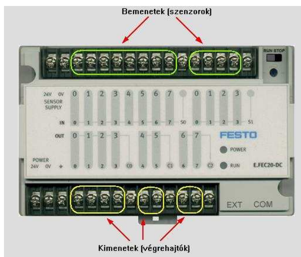
37. ábra. A PLC be- és kimeneti felületei
