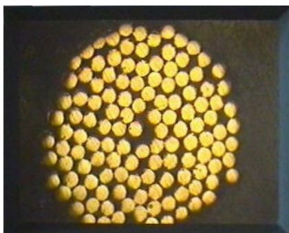
6. ábra. 128 db, 100 \mu\text{m} átmérőjű egységből felépülő 45°-os hegyes MEA, foto optikával nagyítva Fotó: Saját felvétel
