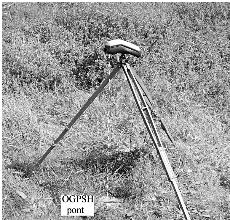
17. ábra. A háromszögelési pontok mérésének módja.
