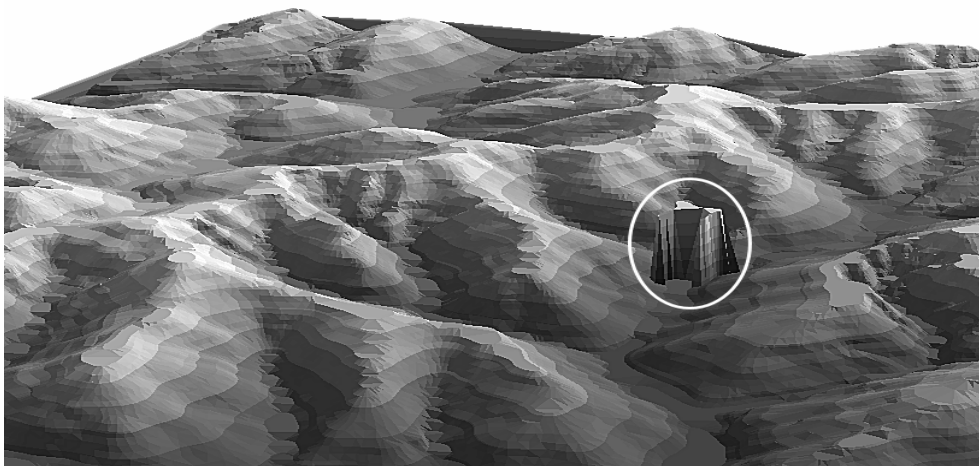
2. ábra. Magassági érték téves megadásából származó hiba megjelenése a digitális magasságmodellen
