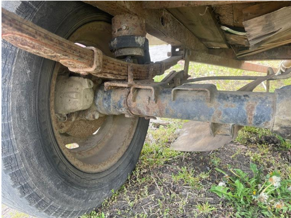
5. Saját fotó a Dacia 1307 hídra épített utánfutó
