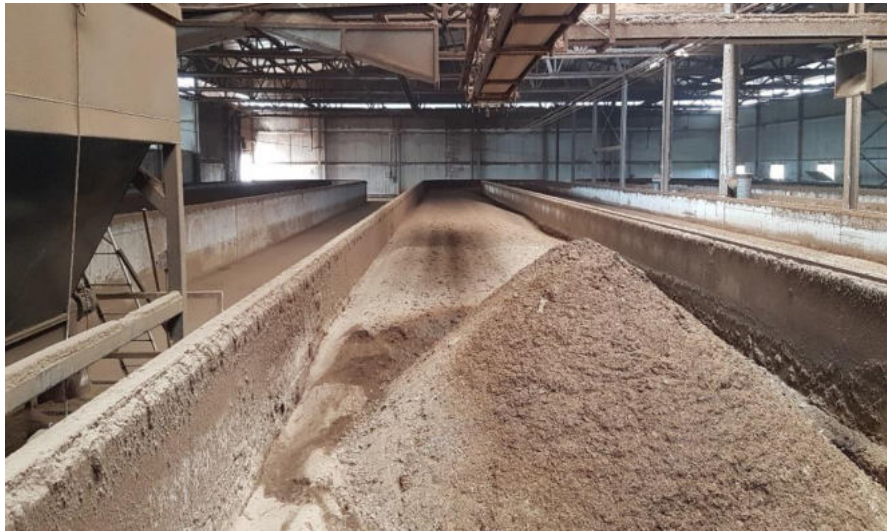
1. kép: A Hosoya trágyafermentáló kád, benne a broiler csirketrágyával
