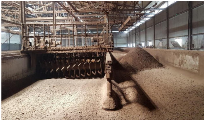
2. kép: A keverőgép a Hosoya trágyafermentáló kádban
