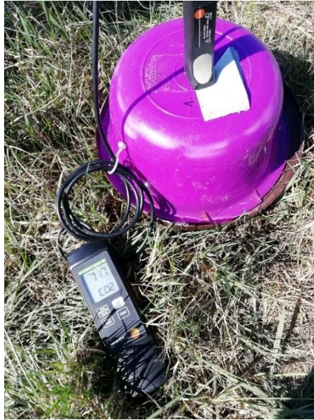
6. ábra Testo 535 infravörös gázanalizátor , valamint a szén-dioxid-kibocsátás méréséhez használt keret (Forrás: Saját fénykép)
