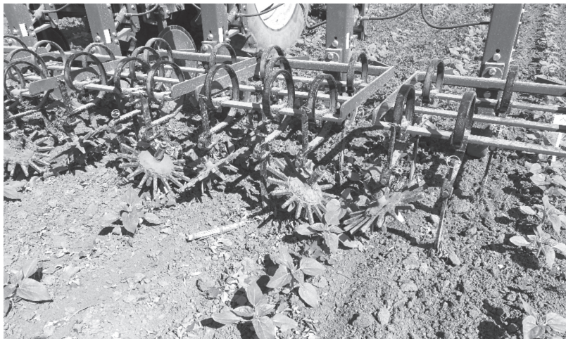
3. ábra: Az ujjas gyomirtók pozíciója a kísérlet beállítása során Figure 3: Finger weeder setup during the experiment
