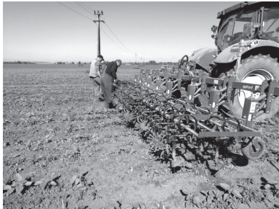
5. ábra: A nyolc soros Garford Robocrop kultivátor beállítása
