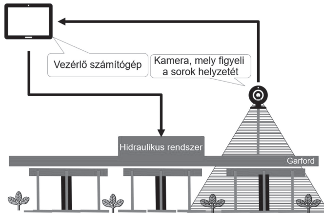
4. ábra: A Garford Robocrop kultivátor működési elve (Borsiczky, 2016)
