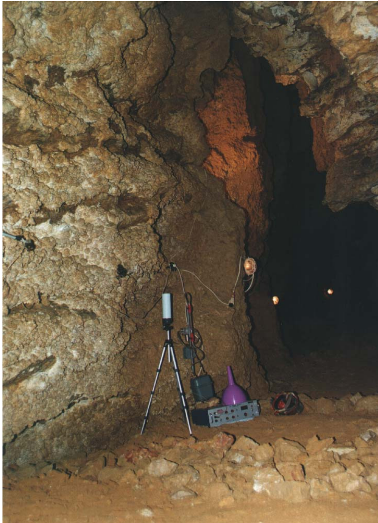
7.9. ábra. Mintavétel kaszkád impaktorról az Agyagosban
