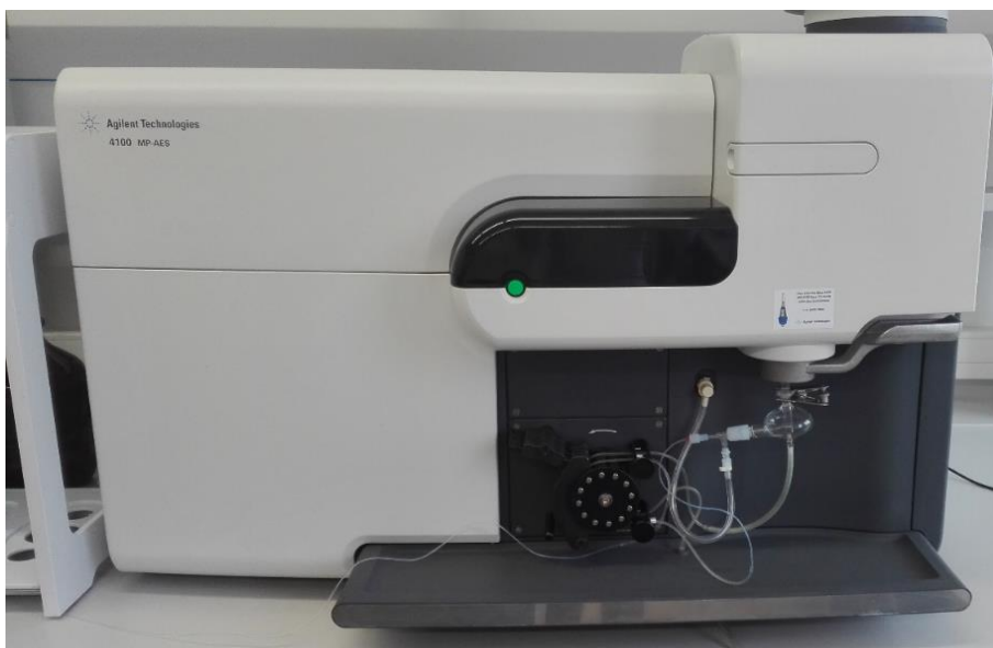
2. ábra A mikrohullámú plazma atomemissziós spektrométer (MP-AES, 4200 Agilent Technologies)
