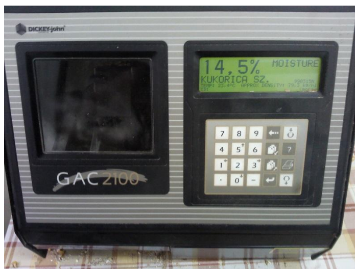
10. ábra: Dickey-John GAC 2100 gabona analizátor ( Forrás: saját felvétel )
