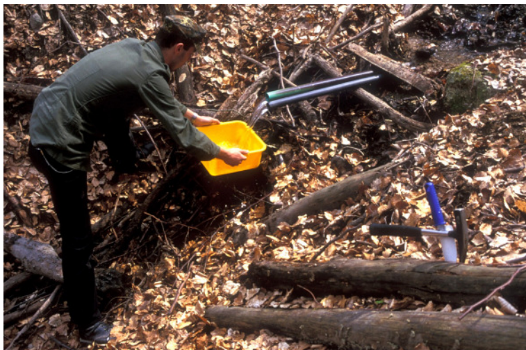
1. kép Vízhozam mérés köbözéssel, egyénileg beépített kifolyócsővel.
