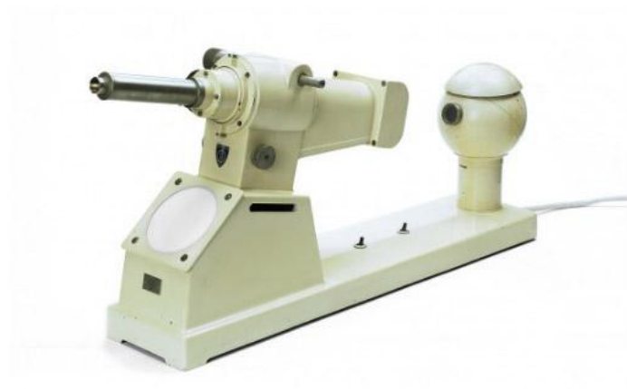
2.3. ábra. Nagel anomaloszkóp
