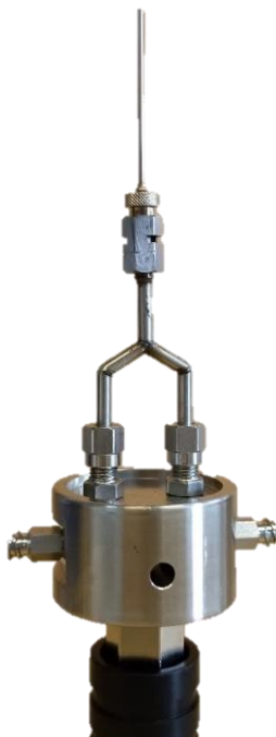
10. ábra Keverővel ellátott saját fejlesztésű emitter.
