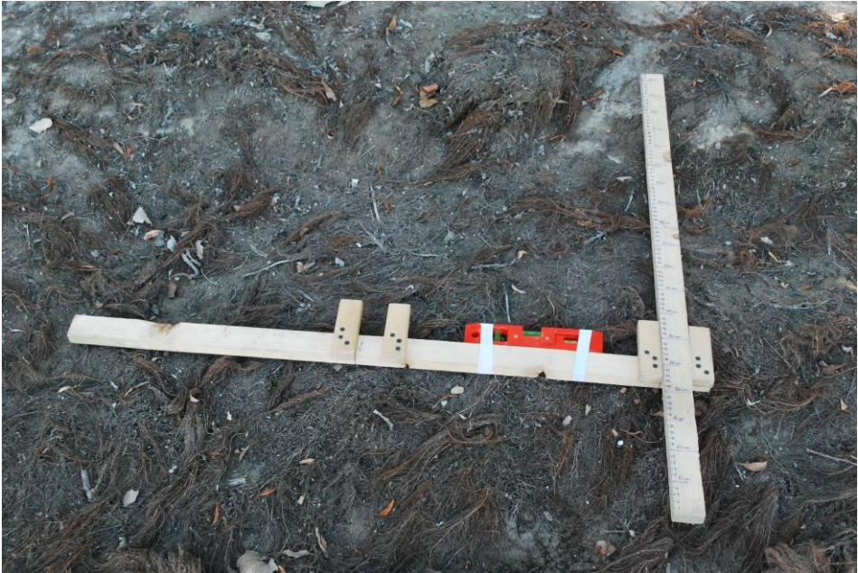
30. kép. A partmeredekség felvételéhez használt eszköz.
