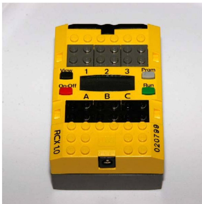
4. ábra: Az RCX 1.0 verziója, a csatlakoztatható érzékelőkkel és beavatkozókkal
