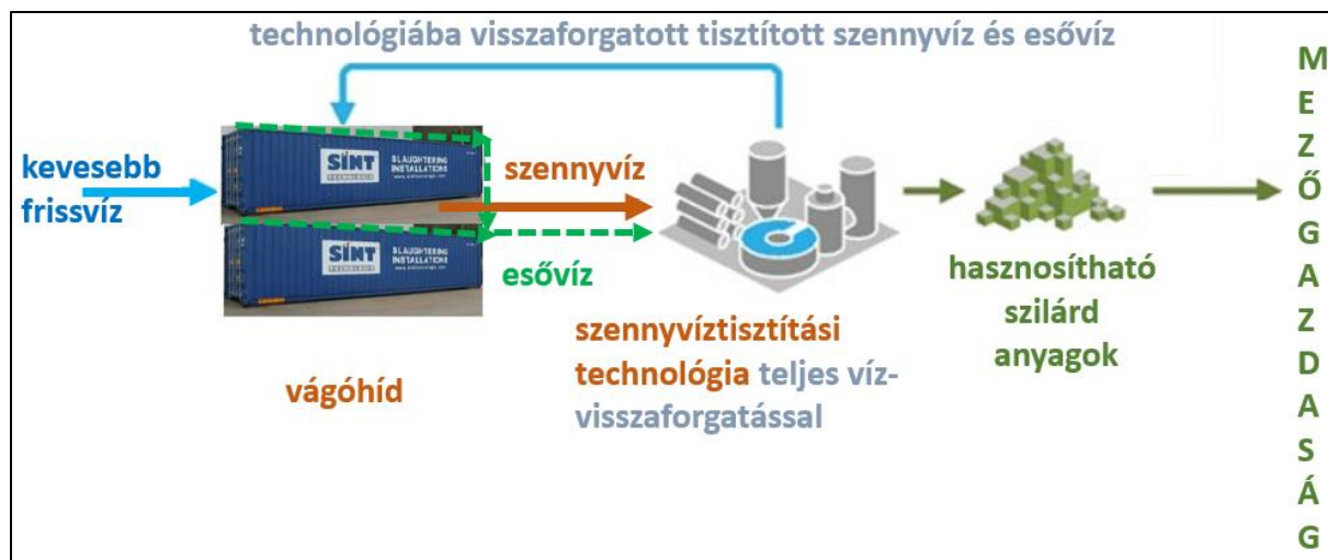
2. ábra: A körkörös gazdaság elvét követve a szennyvízből és a tetőről összegyűjtött esővízből technológiai vizet állítunk elő
